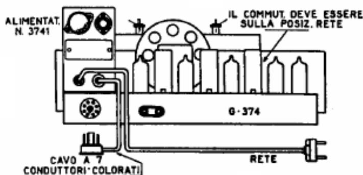
A sinistra: Ricevitore G 374 con alimentatore per rete c.a. Per l'uso: innestare la spina ad 8 piedini e spostare il commutatore dell'apparecchio sulla posizione « rete ».
