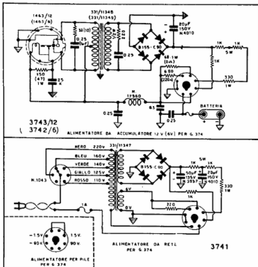
**N. 3741 - Alimentatore per l'alimentazione del G 374 con tensione alternata 50 Hz.** Entrata: 110, 125, 140, 160, 220 V. Uscita: 90 V c.c. (per l'alimentazione anodica e dei filamenti in serie) e 6 V c.a. per l'alimentazione delle lampadine d'illuminazione. Munito di cambio tensioni, fusibile tarato 1 A, cordone di collegamento al ricevitore con spina « octal », cordone di collegamento alla rete con spina-luce. Dimens. d'ingombro cm 11,5 x 7 x 11,5. Peso netto circa gr 880.
